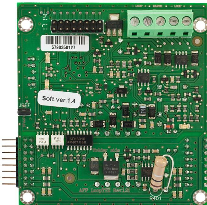
Carte d'extension 1 boucle pour centrale adressée Atena. Nombre maximum de dispositifs acceptés : 250. Courant maximum absorbé : 500 mA Section des câbles utilisables : 0,4 - 2,0 mm<sup>2</sup> Température de fonctionnement -10 °C / +65 °C. Humidité relative de fonctionnement : (93 ± 3) % @ 40 °C. Dimensions : 75x80mm Poids : 30 g
