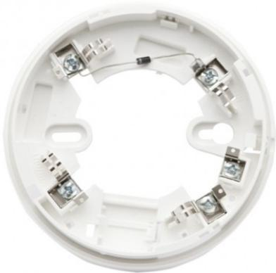
La base standard à diode pour les détecteurs normalisés est particulièrement discrète et le système de connexion au détecteur particulièrement fiable permet également le verrouillage de sûreté de ce dernier. La diode permet de signaler si le détecteur a été démonté de sa base.
